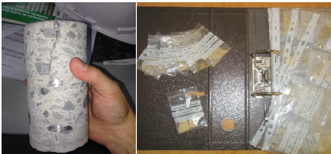
a) Carote de pavimento em betão b) Amostras de reboco em pó identificadas em saquetas [30]
