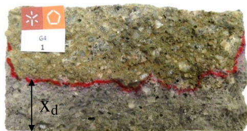
Fig. 15.4 – Profundidade da penetração de cloretos ( X_d ) de um provete [15.1]
