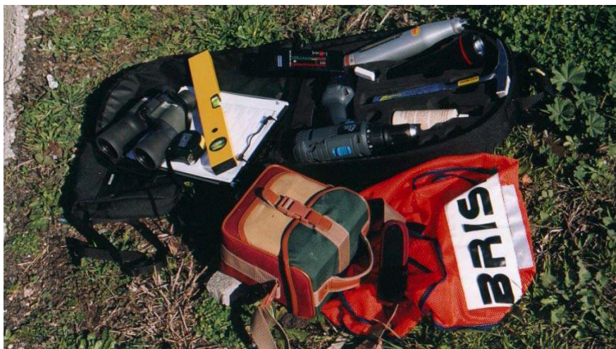
Figura 2.3 – Equipamentos utilizados na inspeção preliminar [31]
