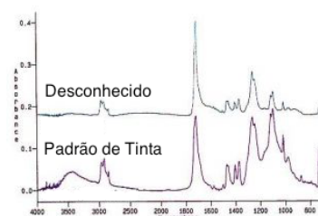
Fig. 5.5 – Espectro FTIR na análise de tinta [5.1]
