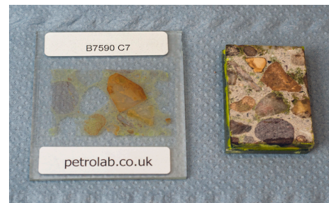
Fig. 2.5 – Amostra preparada em lâmina de vidro junto da seção de betão utilizada para a preparar [2.6]
